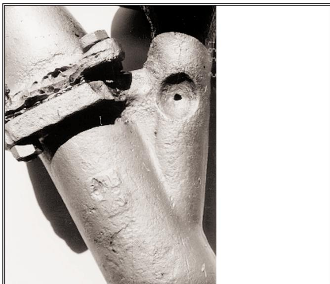
Bild 6b: Streustromkorrosion an einem Schieber
